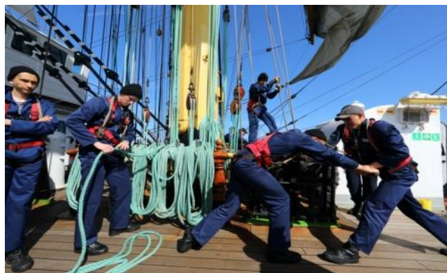
Рисунок 2 – Работа на марсофальной лебедке
